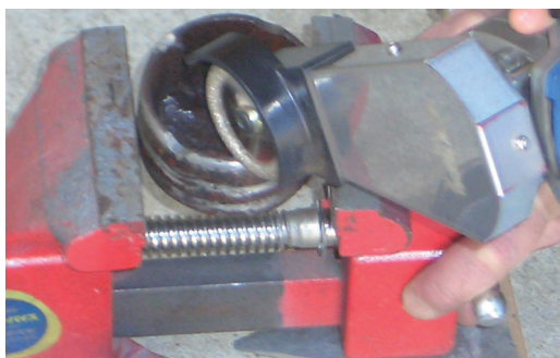
鉄骨品加工 (Uカット溶着ダイヤモンドU50 使用)
